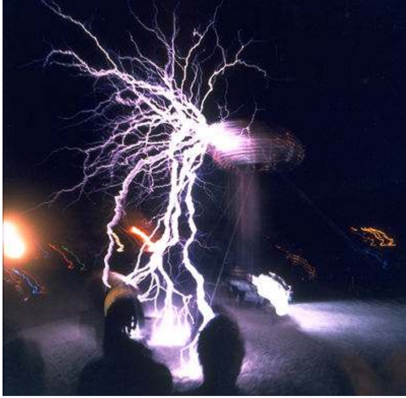
الجهد الذي ينتج من النهاية العليا للاسطوانة أكبر بكثير من جهد الدخل
