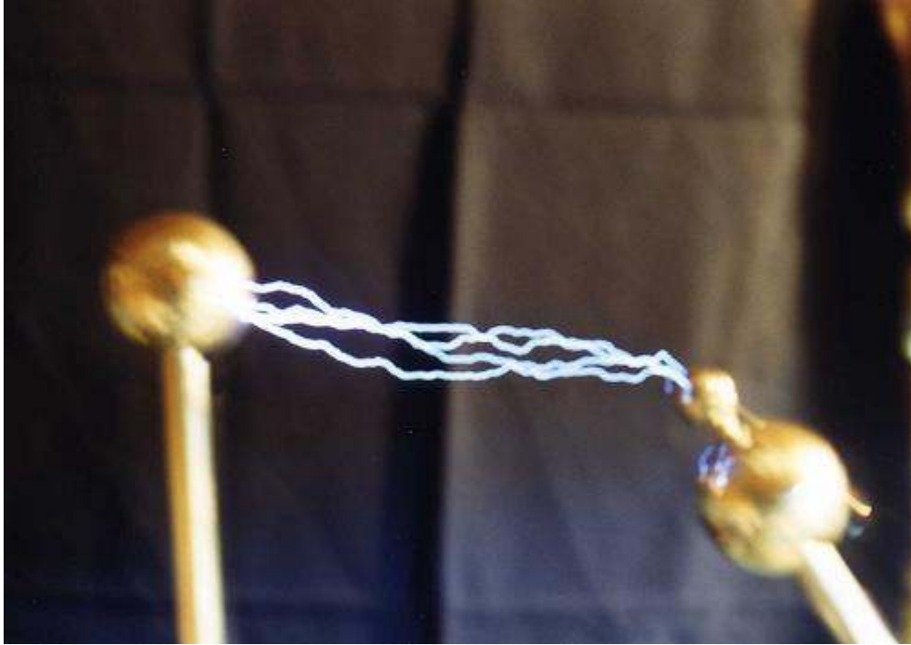
الشرارة الناقلة كهربائياً، قابلة لأن تُخمد مغناطيسياً!
