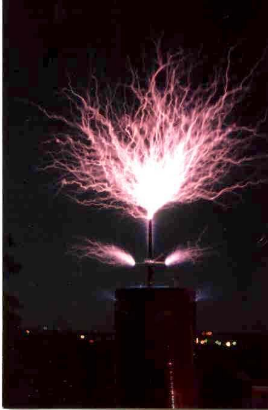
تفريغات على شكل شعيرات شرارية واسعة الانتشار (عندما تكون المنافذ كهروموجبة)
