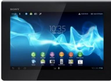
كمبيوتر لوحي جديد من شركة سوني، قياس شاشته يبلغ **9.4** إنش ويعمل بالاعتماد على نظام التشغيل **Android 4.0.3** (المسمى آيس كريم ساندويتش) وعلى معالج رباعي النواة بسرعة **1.3GHz**... للجهاز كاميرتان، خلفية بكثافة رقمية **8** ميغابيكسل وأمامية بميغابيكسل واحد... سعة الذاكرة الداخلية تتراوح بين **16-32-64GB** يمكن زيادتها باستخدام بطاقة **microSD**.
